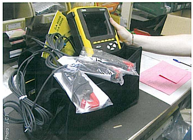
Dans l'atelier de personnalisation des produits finis : des accessoires sont associés à l'analyseur de réseau Qualistar.
