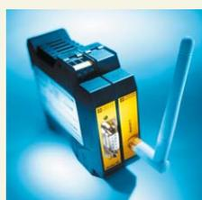
**Le Bluetop® 100** utilise la dernière technologie sans fil Bluetooth®. Conçu pour travailler dans un environnement industriel en liaison point par point, il remplace les liaisons filaires RS 485 et RS 232 sur une longueur de 100 mètres ou plus. Ce nouveau produit **PYRO-CONTRÔLE** assure une transmission fiable et sécurisée des données sans contraintes de passage de câbles et de soucis de connexions mécaniques.
