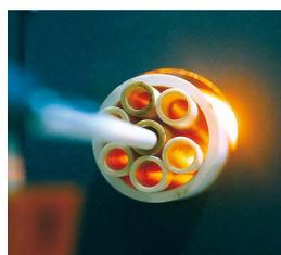
• **Un service de métrologie habilité COFRAC.** Ce laboratoire (accréditation Cofrac n°2-1385) réalise l'étalonnage des capteurs par comparaison et délivre un certificat d'étalonnage. Le domaine de mesure s'étend de -20°C à +450°C pour les sondes Pt 100 Ω et de -20°C à +1550°C pour les thermocouples.
