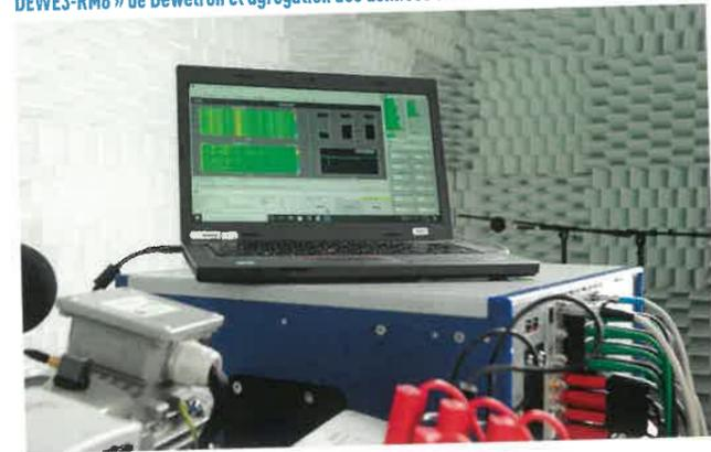
Mesure embarquée et interactions automatisées avec le frontal mobile MicroQuantus via PAK live et PAK capture
