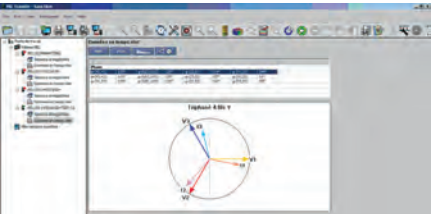
Modulo PEL TRANSFER Visualizzazione a distanza di una rappresentazione vettoriale
