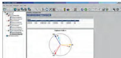
Modulo PEL TRANSFER Visualizzazione a distanza di una rappresentazione vettoriale
