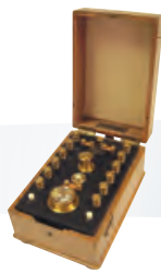
Este potenciômetro de calibração de 1900 foi usado com uma bateria padrão e um galvanómetro como o mostrado acima. Preço: 195 francos!
