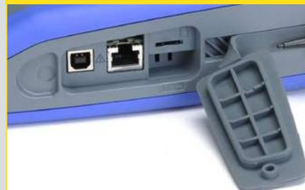
Las interfaces de comunicación están agrupadas en un espacio dedicado en el lado derecho del producto, protegido por una tapa de protección: USB host, Ethernet alámbrico o WiFi para la comunicación con un PC o impresión hacia una impresora de red y, por último, la  $\mu$ SD de alta capacidad para el almacenamiento de datos sin preocupaciones de transferencia.
