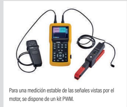
Para una medición estable de las señales vistas por el motor, se dispone de un kit PWM.
