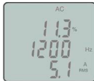
Anzeige der F407 Messung der Oberschwingung 3. Ordnung (H3) bei einer Grundfrequenz von 400 Hz
