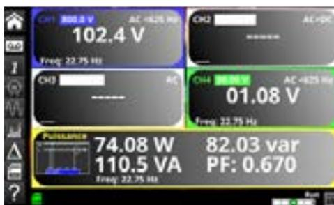
Ci-contre, une mesure de puissance en monophasé, avec le filtrage à 625 Hz. On voit que la fréquence est bien celle délivrée par notre variateur, notre facteur de puissance est donc correct. Les mesures n'ont pas été effectuées exactement dans les mêmes conditions, c'est pourquoi le courant et la tension sont différents.
