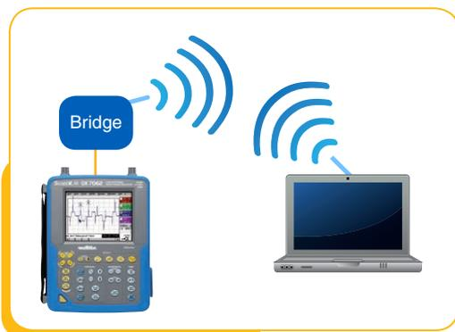
Un'altra applicazione è possibile con l'HX0090, questa volta in modalità Ad-Hoc. Il PC e l'oscilloscopio possono comunicare direttamente. Le reti Ad-hoc sono reti wireless in grado di organizzarsi in assenza di infrastrutture definite preliminarmente. Perciò il problema delle Ad-Hoc sono numerosi (banda passante limitata, perdite di dati, sicurezza molto limitata, interferenze, ecc.).
